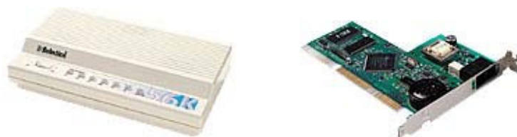
รูปที่ 1 แสดงโมเด็มชนิดติดตั้งภายนอก (ซ้าย) ชนิดติดตั้งภายใน (ขวา)
